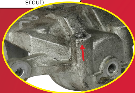
Ve třmenu zůstává prasklý odvzdušňovací šroub
